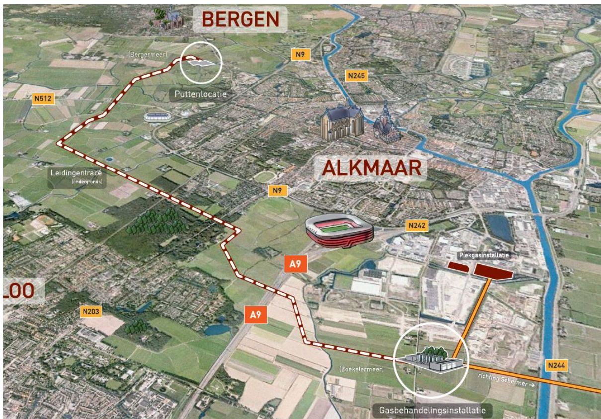
Figuur 1 Puttenlocatie, behandelingsinstallatie en verbindende ondergrondse pijpleidingen tracé.
